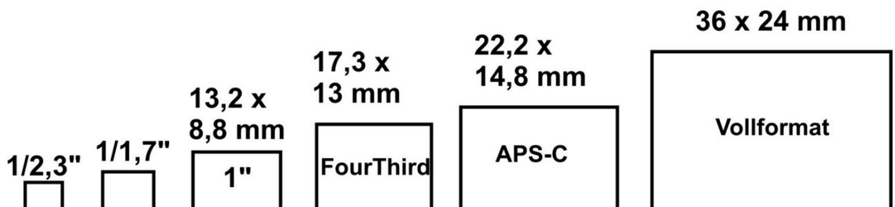
Da man bei einem größeren Sensor mehr Fläche für die einzelnen Pixel zur Verfügung hat, sind diese lichtempfindlicher und können rauschärmere Bilder produzieren. Es gibt natürlich auch die Möglichkeit, weniger Pixel auf einem kleineren Sensor unterzubringen. Dadurch gäbe es auch mehr Platz für die einzelnen Pixel. Bei manchen, wenigen Kameras wird das auch so gemacht.
