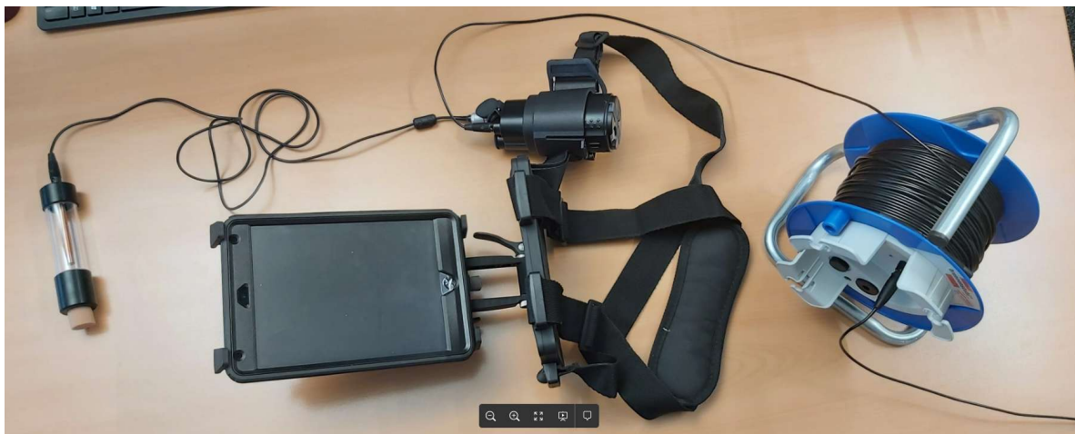
Abbildung 7 : PM8500 Stabelektrodenverkabelung eingerichtet
