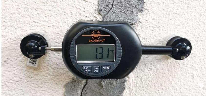
Das E1-Riss-Messgerät dient zur Überwachung der Rissentwicklung auf 1 Achse (Spreizung) oder auf 2 Achsen (Spreizung und Scherung). Es ermöglicht zuverlässige Messungen mit einer Auflösung von 0,01 mm und einer Wiederholpräzision von +/- 0,01 mm.
