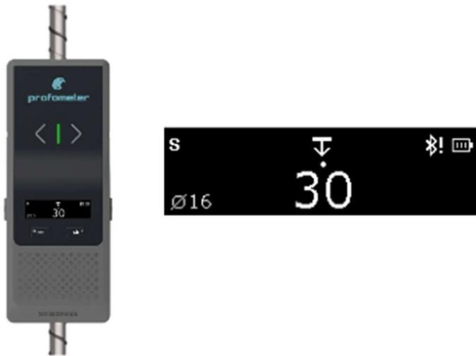
Abbildung 40: Anzeigen eines Bewehrungsstabes
