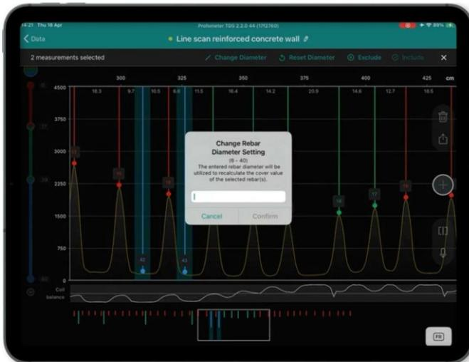
Abbildung 59: Kundenspezifische Einstellung des Bewehrungsdurchmessers
