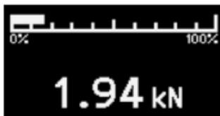
Der Belastungsanstieg wird in der Messanzeige dargestellt. Eine Nenn-Belastungsgeschwindigkeit wird angewendet, bis eine Kraft von 250 N (56 lbf) erreicht ist. An diesem Punkt wird für die Dauer des Tests die programmierte Belastungsgeschwindigkeit angewendet.
