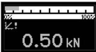
Die wahrscheinlichste Ursache hierfür ist die plastische Verformung des zu prüfenden Substrats oder Materials oder die Einstellung einer für das Gerät nicht realisierbaren Belastungsgeschwindigkeit (siehe Technische Daten).
