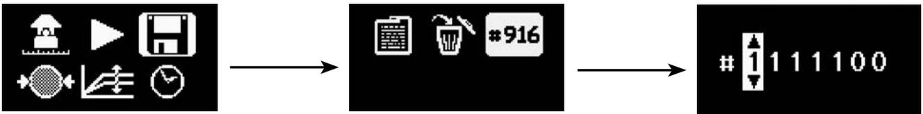
Der Benutzer kann die Testnummer (ID) einstellen. Hinweis: Nach jeder Messung erfolgt eine inkrementelle Erhöhung der Testnummer.
