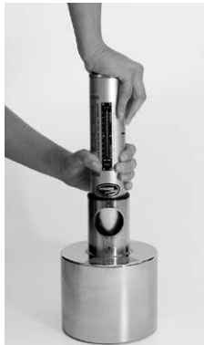
Fig. 3.1 Funktionskontrolle des Betonprüfhammers (Modell N/L abgebildet)
