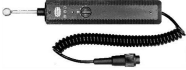
mit integrierter Elektronik zum zerstörungsfreien Aufspüren von Feuchtigkeitskonzentrationen in Bauteilen aller Art sowie zur Erkennung der Feuchtigkeitsverteilung in Fußböden, Wänden und Decken.
