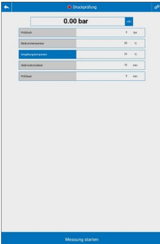
Abb. 16: Voreinstellungen Druckprüfung an Wasserleitungen mit Wasser
