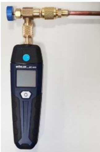
Abb. 10: Wöhler SC 660 an Kälteanlage angeschlossen
