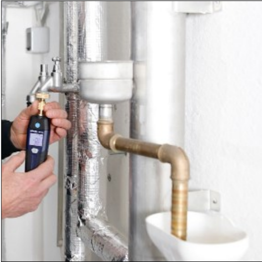
Abb. 5: Anschluss mit Messadapter (Art. Nr. 8856)
