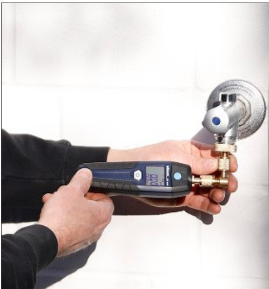
Abb. 6: Anschluss mit Winkeladapter 90° (Art. Nr. 8841)
