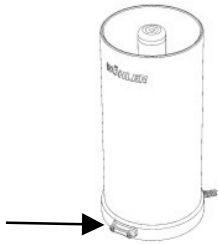
Abb. 46: Kalibrierbuchse für Prüfstelle, mit Pfeil markiert
