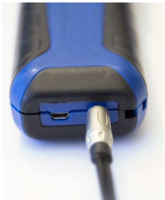
Abb. 13: Geräteunterseite mit angeschlossenen Kabel der Einschlagsonde
