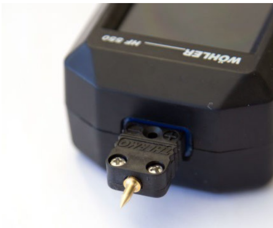
Abb. 12: Geräteoberseite mit eingesteckter Temperatursonde
