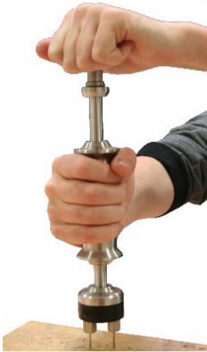
Abb. 16: Einschlagen der Wöhler Einstechsonde
