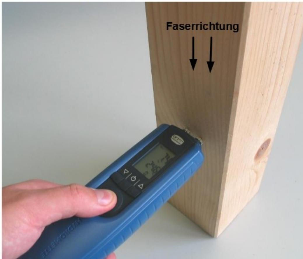
**Abbildung 4-1 Messung quer zur Faserrichtung**
