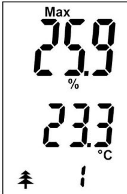
Angezeigt wird der größte Feuchte-Messwert einer Messreihe zusammen mit Displaysymbol „Max“
