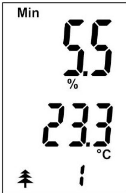
Angezeigt wird der kleinste Feuchte-Messwert einer Messreihe zusammen mit Displaysymbol „Min“
