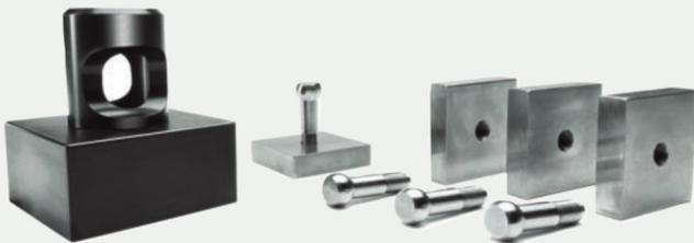
Mit dem Fliesen-Set 50T kann der PosiTest AT die Zugfestigkeit von z. B. Zementkleber oder Dispersionskleber für Fliesen messen.
