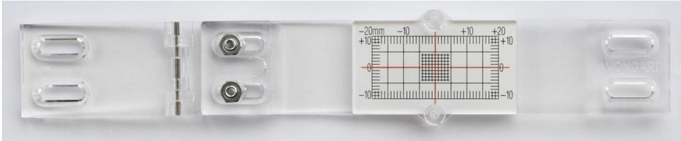
Besteht nur aus einem Teil vom TT 3 (TT 1 mit Winkel). Der mitgelieferte Adapter wird hier an dem Teil des Monitors mit der Messskala befestigt wie unter TT 2 Ecke beschrieben. Der mit Langlöchern versehene Schenkel des Adapters wird bei Installation an der Bodenplatte/Geschoßdecke befestigt, der gegenüberliegende Monitorteil am vertikalen Bauteil.
