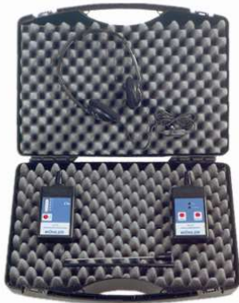
Abbildung 11.1: Komplettkoffer mit Kopfhörer und Körperschallsonde
