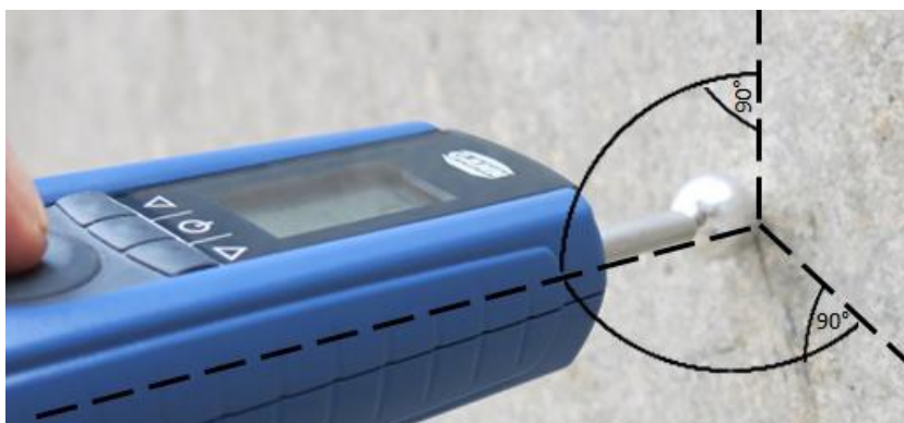
Abbildung 4-3 Messung möglichst senkrecht zur Messfläche
